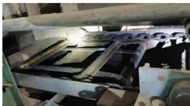
图4 干式刮板清料器实物图
