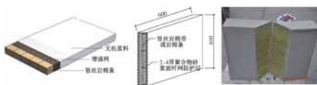
图1 增强竖丝岩棉复合板示意
